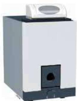
Corpo de caldeira formado por elementos de fundição com elevada permuta de calor e grande caudal de água. Fornalha em sobrepressão de elevada eficiência e com duplo isolamento em fibra de vidro com 50 mm de espessura.
