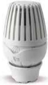
Cabeçal termostático com sensor líquido. Sistema de encaixe rápido Clip-Clap, com posições de regulação de frio a calor, que correspondem a um intervalo de temperaturas de 8 a 32 °C.
