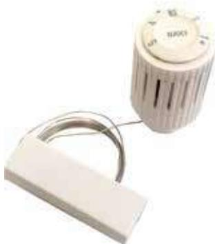
Cabeçal termostático com sensor líquido remoto e sistema de encaixe rápido Clip-Clap, com posições de regulação de frio a calor, que correspondem a um intervalo de temperaturas de 8 a 32 °C.
